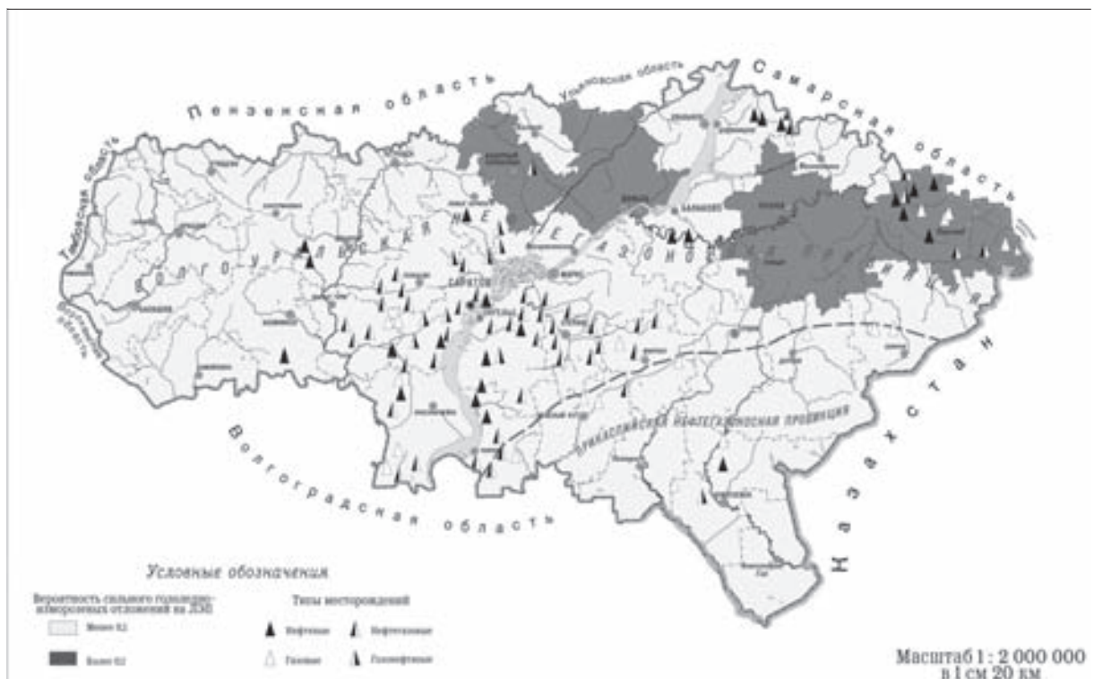
Рис. 1. Прогноз проявления сильного гололедно-изморозевых отложений на проводах в 2010 г.
