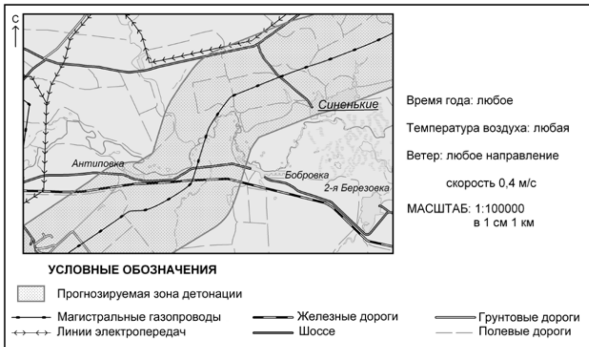
Рис. 4. Моделирование зоны детонации при возможной разгерметизации газопровода
