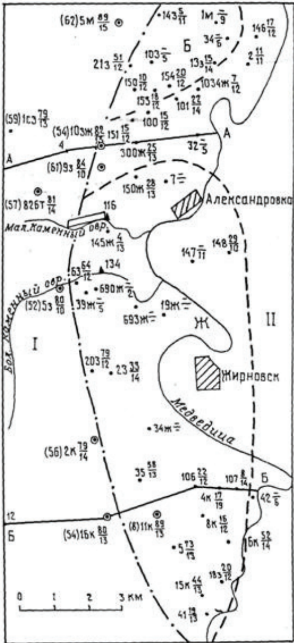
Рис. 2. Расположение скважин (кружки) и обнажений (треугольники) на правом берегу Медведицы; двойным кружком обозначены скважины, вскрывшие каменноовражную свиту, мощность которой указана в скобках; в числителе – мощности жирновской свиты, в знаменателе – мощности караулинской свиты; прочерки обозначают отсутствие отложений данной свиты; прямоугольник ограничивает площадь обнажений; штрих-пунктир – Западно-Жирновский разлом, разграничивающий Терсинскую впадину (I) и Жирновско-Иловлинский вал (II); локальные поднятия: Б – Бахметьевское, Ж – Жирновское; цифры обозначают номера скважин: без индекса – собственные картографические; с индексом – структурные (площади: м – медведицкая; сз – сазоновская; з – жирновская (по Т.Н. Золотовой, 1949); к – куракинская (по Р.И. Фан-Юнг, 1958); т – терсинская (по Р.И. Фанг-Юнг, 1959); ж – жирновские эксплуатационные). Схема составлена В.Ф. Салтыковым
