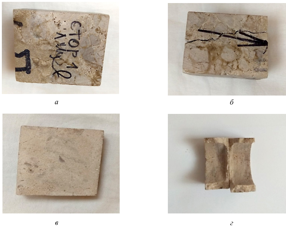
Рис. 7. Фрагмент № 4.4 в разрушенном состоянии: вид сверху (а) и сбоку (б). Фрагменты образца № 4 (в), (г) в интервале 976.86–976.96 характеризуются отсутствием макротрещин и крупных каверн (цвет онлайн)
