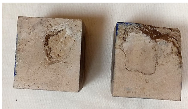
Рис. 5. Фрагменты № 3.5 (слева) и № 3.6 (справа). Во фрагменте № 3.6 хорошо прослеживается стилолитовый шов с глинистым заполнением (цвет онлайн)
