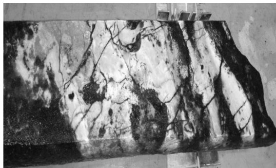
Рис. 7. Макротрещины в образцах известняков в интервале 963.0–964.0 м (М. А. Лоншаков, 2020 г.)
