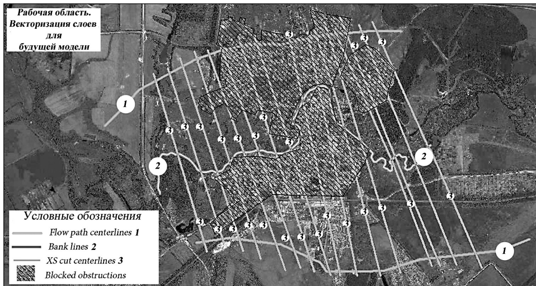
Рис. 3. Тематические слои будущей математико-картографической модели, созданные с помощью модуля HecGeoRas ArcGIS v.10.2
