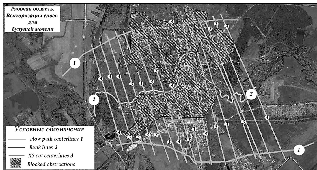
Рис. 3. Тематические слои будущей математико-картографической модели, созданные с помощью модуля HecGeoRas ArcGIS v.10.2
