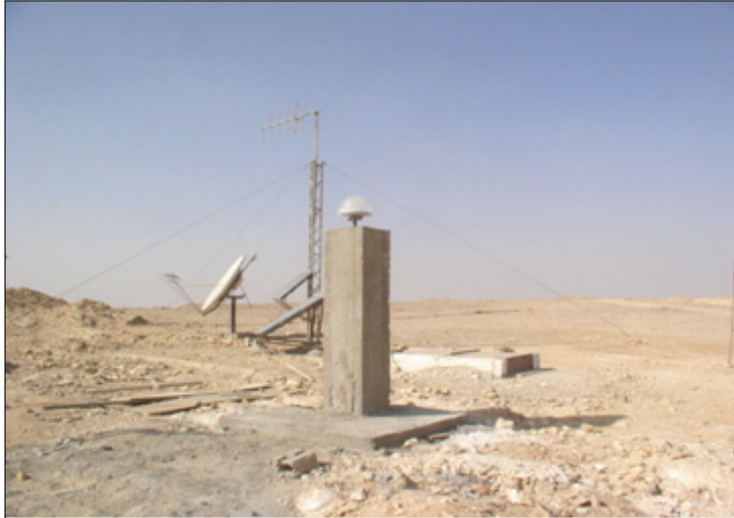
Рис. 2. GPS станция в Катамии (один из 13 пунктов геодезической сети)
