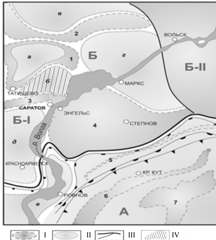
Рис. 1. Тектоническая схема центральной части Саратовской области Условные обозначения: I – зоны поднятий: 1 – Саратовские дислокации, 2 – Петровско-Карабулакский вал, 3 – Елшано-Сергиевский вал, 4 – Степновский сложный вал, 5 – Мокроусовский вал, 6 – Ерусланский вал, 7 – Мироновская; II – зоны погружений: а – Корсаковская впадина, б – Свинцовская впадина, в – Дубровский прогиб, г – Воскресенская впадина, д – Карамышская впадина, е – Волжский прогиб; III – границы структурных зон: А – Прикаспийская синеклиза; Б – Волго-Уральская антеклиза; Б-I – Рязано-Саратовский прогиб, Б-II – Жигулевско-Пугачевский свод; IV – территория исследований
