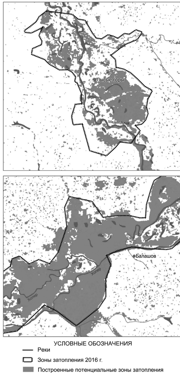
Рис.3. Фактические и смоделированные зоны затопления территории в пределах гидропостов Лысье горы и Балашов
