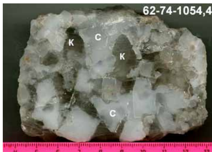
Рис. 3. Порода карналлит-сильвинового состава. (сильвин – С, карналлит – К). Даргановский участок, скв. 62, обр. 74, гл. 1054,4 м (долинная ритмопачка)
